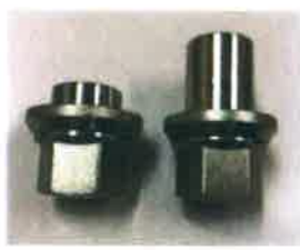
専用スリーブナット 左:単輪用 右:複輪用
